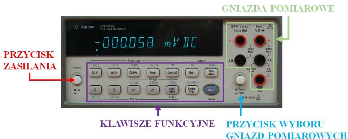
Rys. 1. Panel czołowy multimetru Agilent 34401A
