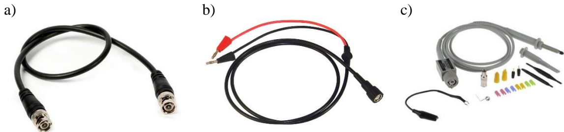
Rys. 4. Przykładowe przewody do podłączenia oscyloskopu do badanego układu: a) przewód BNC-BNC, b) przewód BNC-2 × banan 4 mm, c) sonda oscyloskopowa
