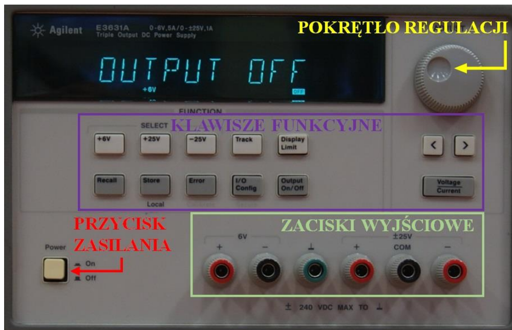
Rys. 1. Panel czołowy zasilacza laboratoryjnego Agilent E3631A
