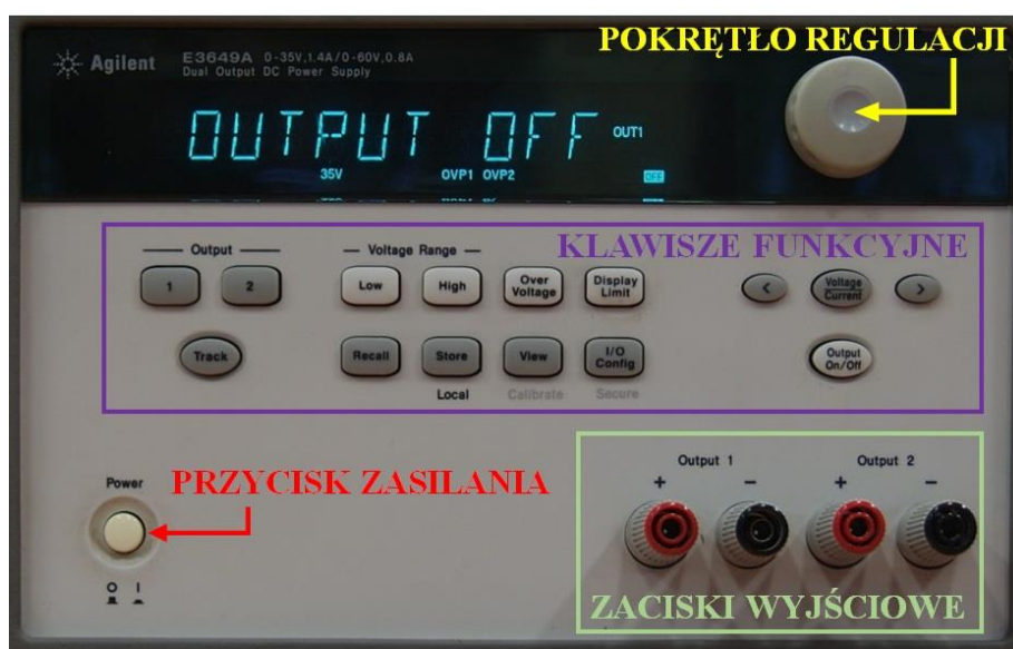
Rys. 1. Panel czołowy zasilacza laboratoryjnego Agilent E3649A
